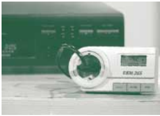
Energie-Messgeräte können Stromfresser entlarven.
