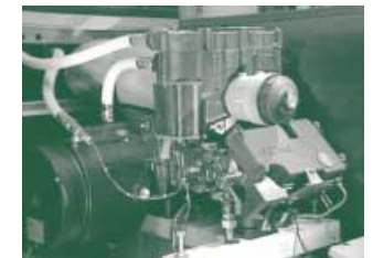
Herz eines Minikraftwerkes ist ein robuster Motor. Die Schläuche leiten das Kühl- bzw. Heizwasser ab.
