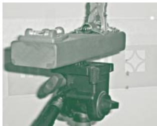
Die Kreuzwasserwaage (links) sorgt fur einen absolut ebenen Stand. Das Fotostativ kann horizontal und vertikal geschwenkt werden.
