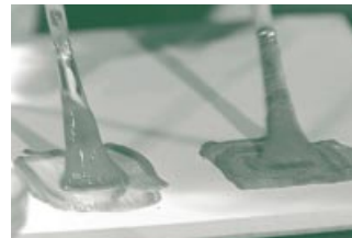
Links Terra di Siena, rechts in gleicher Konzentration synthetisch gewonnenes Eisenoxid.
