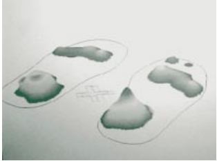
Mit Hilfe von Sensortechniken lässt sich genau ermitteln, welcher Druck bei welchem Boden auf den Füßen lastet. Bei harten Fliesen ist er wesentlich größer als bei Teppich.
