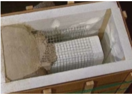
Ein eingeklebter Styroporkern bringt zusätzliche Leichtigkeit
